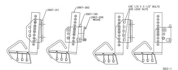
FOR HEAVY DUTY "WELDED" AND CAST "LONG" LOWER PARALLEL ARMS FOR LIGHT DUTY OR HEAVY DUTY CAST LOWER PARALLEL ARMS ALSO: JD 7000, KINZE & WHITE 6100
