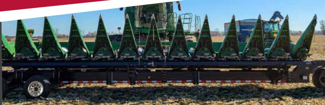
\*El remolque de cabezales se muestra con Stalk Devastator 5000 instalado en un cabezal de maíz.
