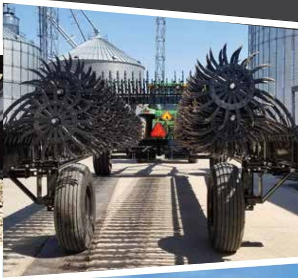
**Las azadas rotativas remolcadas 3600 de Yetter se pliegan para facilitar su transporte a una anchura de 35 m (11,5').**
