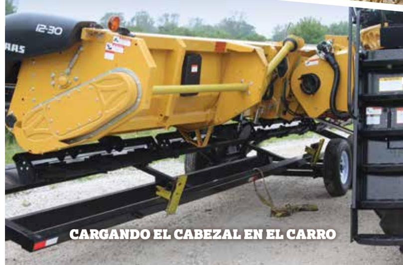
**CARGANDO EL CABEZAL EN EL CARRO**
