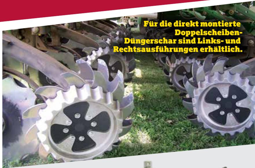
Für die direkt montierte Doppelscheiben-Düngerschar sind Links- und Rechtsausführungen erhältlich.
